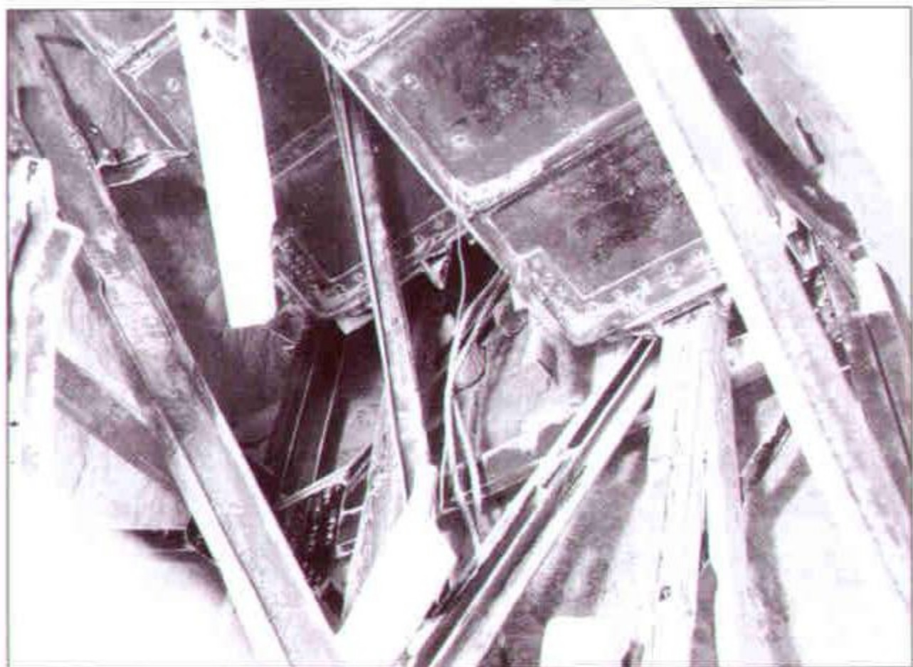
Bild 11b - Durch den CO 2 -Hurikan im Gesenk 3 aufwärts getriebene Förderkörbe und zerstörte Korbführungen
